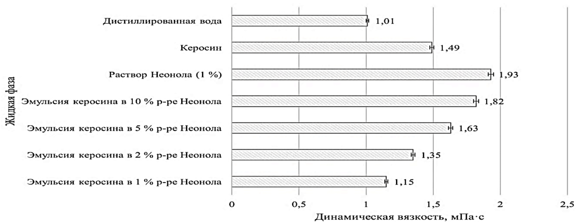
Рисунок 2. Результаты исследования изменения значений динамической вязкости для компонентов эмульсии и эмульсии керосина в растворе пенообразователя
