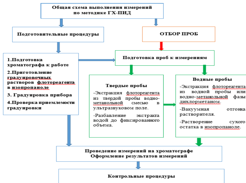
Рисунок. Схема выполнения измерений методом ГХ-ПИД
