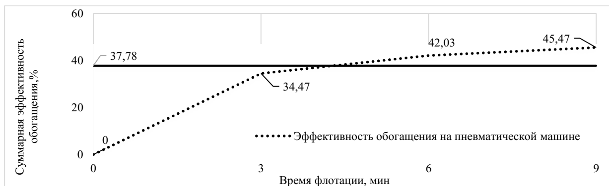
Рисунок 2. Зависимость эффективности обогащения от времени флотации в контрольной Si перечистной операции на опытно-промышленной флотационной машине пневматического типа
