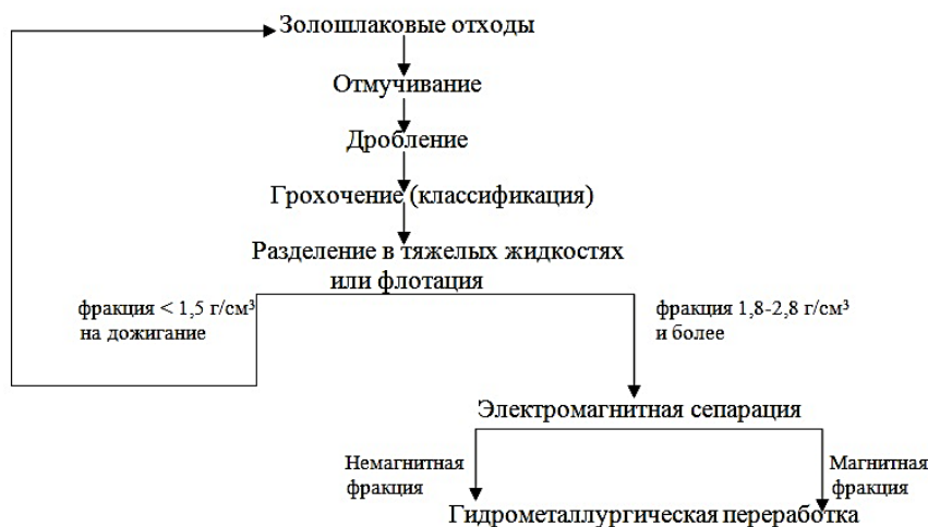
Рисунок. Схема обогащения и гидрометаллургической переработки золошлаковых отходов Приаргунской ТЭЦ
